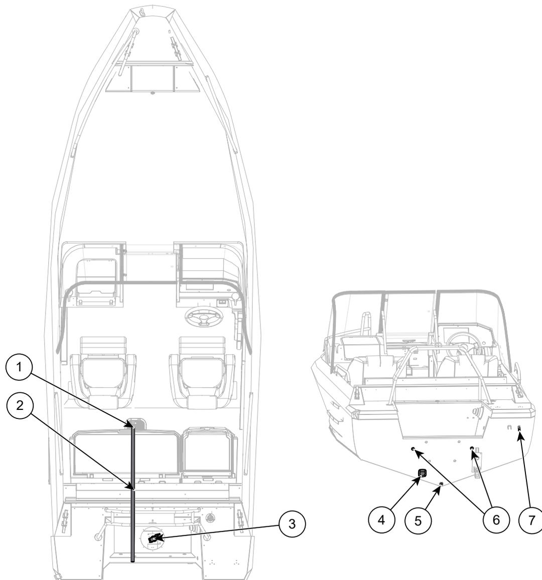
Abbildung 9.1 Buster LX Entwässerungsgeräte
