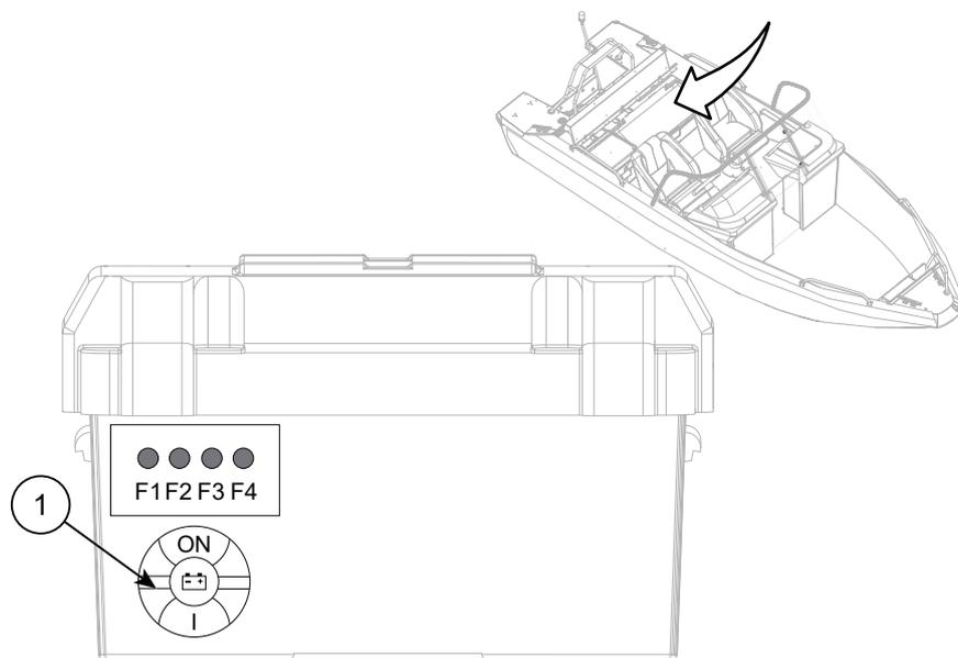
Abbildung 8.1 Buster LX Hauptschalter und Sicherungspanel
