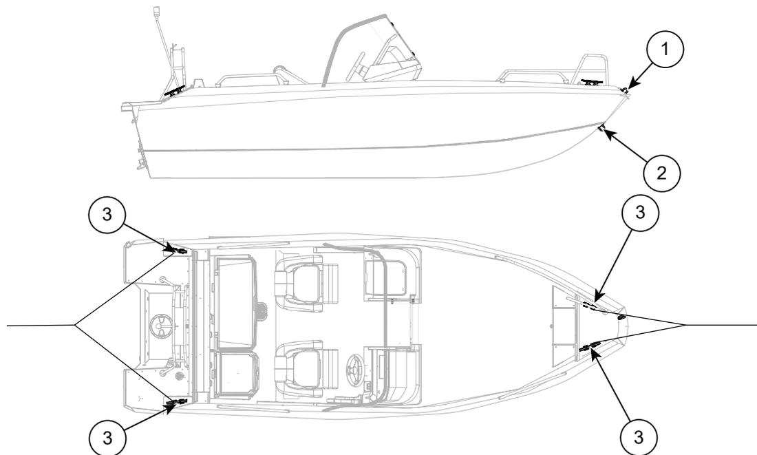
Abbildung 5.4 Buster LX Befestigungs- und Schlepppunkte
